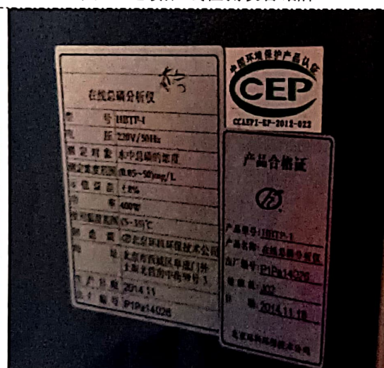
图 7: 总磷在线检测设备铭牌
